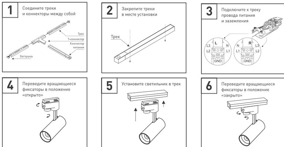
Рис. 7. Установка и подключение светильника
