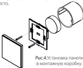
Рис.4. Установка панели управления в монтажную коробку.
