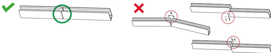
2.9.2. Устанавливайте отрезки профиля без перекосов, которые могут способствовать защемлению «неона» в профиле и его выходу из строя в связи с расширением и сжатием ПВХ-трубки «неона» при высоких и низких температурах.
