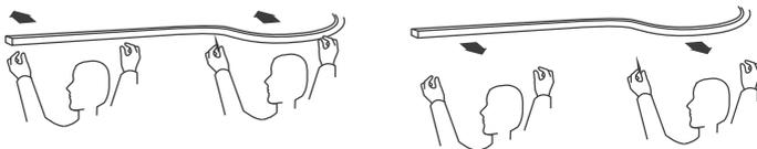
2.13. Для демонтажа «неона» используйте инструмент (отвертку с плоским лезвием).
