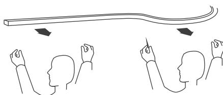
Производите вдвоем монтаж и демонтаж отрезков неона длиной более 2-х метров
