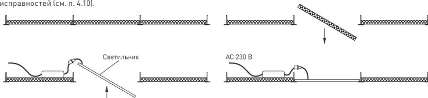
Рис. 1. Установка светильника в ячейку подвесного потолка
