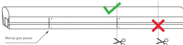
Найдите метки реза, обозначенные на корпусе ленты. Выполните разрез строго по нанесенной линии.
