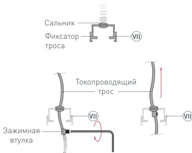
\* В комплект подвеса входят: 1 трос — 2000 мм, 1 токопроводящий трос — 2000 мм, 2 сальника, 2 фиксатора троса, 2 зажимные втулки с винтом, 2 тросовых держателя, 4 крепежных винта.
