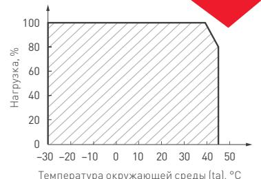
Рис. 1. Максимальная допустимая нагрузка, % от мощности источника
