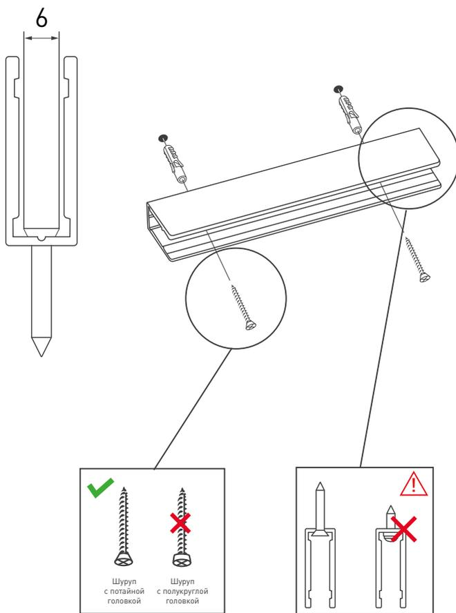
Оптимальное расстояние между шурупами 100 мм. При отсутствии необходимого количества крепежных отверстий на профиле необходимо просверлить недостающие отверстия, равномерно разместив их по всей длине профиля, при этом крайние крепежные отверстия необходимо расположить на расстоянии 50 мм от обрезов профиля.
