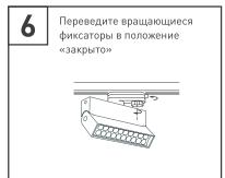
Рис. 2. Установка и полключение светильника
