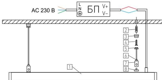
Рис. 2. Монтаж светильника
