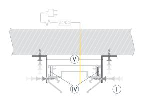
2 / Закрепите полотно натяжного потолка с помощью гарпуна (II) в профиледержателе (I).
