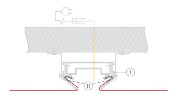
3 / Установите шинопровод (III) в профильдержатель (1). Выполните подключение шинопровода согласно инструкции к нему.
