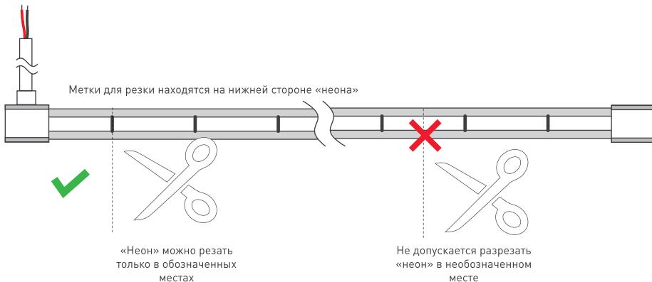
3.2. Со стороны подачи питания сделайте аккуратный надрез на нижней поверхности «неона», обеспечив доступ к контактным площадкам платы. Используйте канцелярский нож с выдвижным лезвием.
