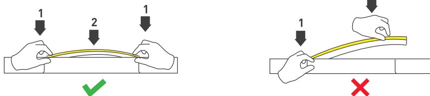
Для демонтажа «неона» используйте инструмент (отвертку с плоским лезвием)
