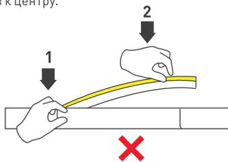
Для демонтажа неона используйте инструмент (отвертку с плоским лезвием)
