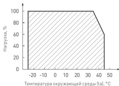
Рис. 3. Максимальная допустимая нагрузка, % от мощности источника
