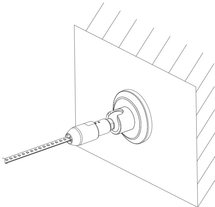
↗ Выровняйте стальную полосу с помощью гаечного ключа на 17 мм и 30 мм.
