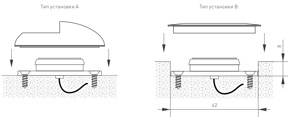
Рис. 2. Типы установки светильников
