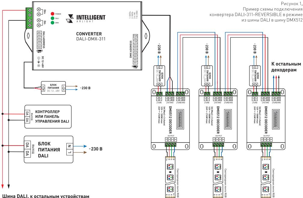
**Примечание.** Установите все переключатели «DMX512 ADDRESS» в положение «OFF», в этом случае из шины DALI будут управляться устройства начиная с адреса 1. Если переключатель «001» установить в положение «ON», то начальный адрес составит 1+1, что равно 2. Если все переключатели установить в положение «ON», то начальный адрес будет равен 511+1, что равно 512.
