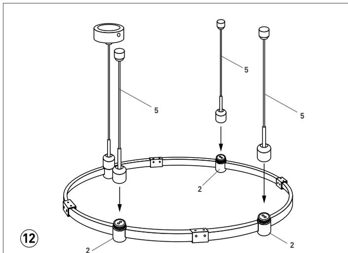
Механическим накручиванием присоедините к держателям (2) подвесы (5)
