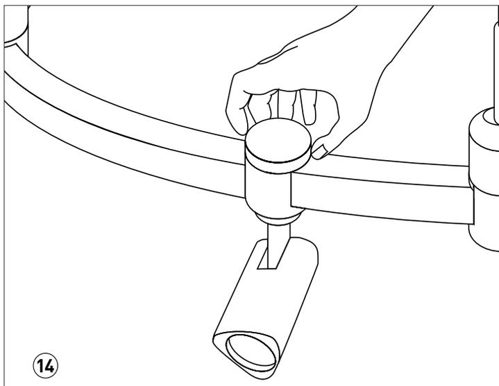
Установите и зафиксируйте механическим накручиванием светильники\*
