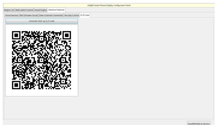
«Generate Start-up QR Code» — сгенерировать QR-код доступа. Данный QR-код позволяет автоматически добавить контроллер в приложение и авторизоваться без ввода логина и пароля.
