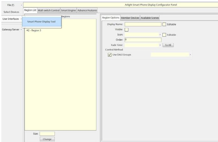
Меню «Smart Phone Display Tool» имеет 4 вкладки: «Region List», «Wall-Switch Control», «Smart Engine», «Advance Features».
