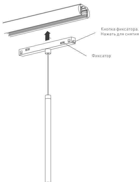
Рис. 2. Установка светильника
