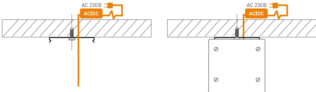
Рис. 1. Установка и подключение светильника
