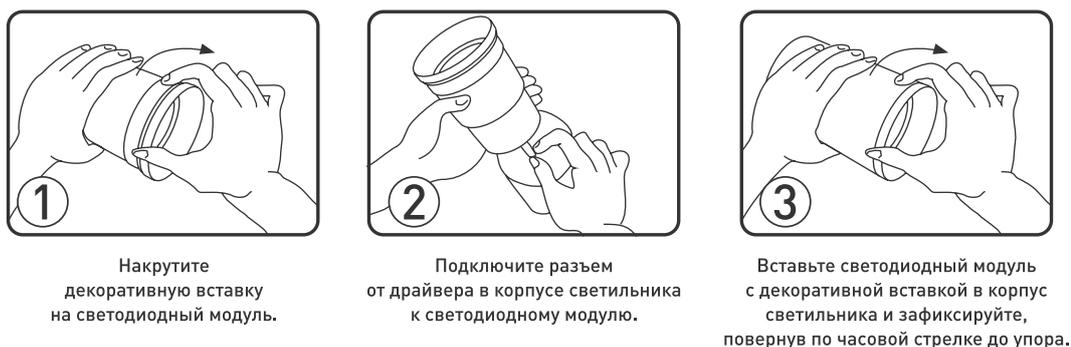
Рисунок 1. Сборка светильника.
