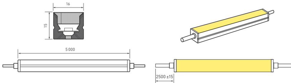
Вывод кабеля питания выполнен сбоку вдоль линии сечения «неона» с двух сторон. Длина кабеля питания —  $2500 \pm 15$  мм. Цветовая маркировка проводов питания: красный провод — «+24 В»; черный провод — «-24 В».
